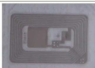
Fig 5 - Chip RFID de memória, embutido na CEV, acionado por radio-frequência
