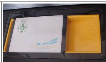
Fig.6 - Impressora e Leitora do Chip incluída na valise
